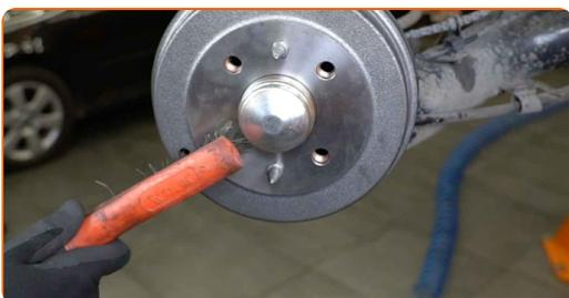
**21** Behandeln Sie die Oberfläche, an der die Radfelge die Bremstrommel berührt. Benutzen Sie ein Kupferschmiermittel.
