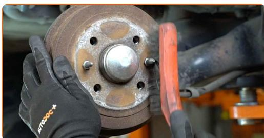
**7** Schrauben Sie die Bremstrommel-Befestigung ab. Verwenden Sie Stecknuss Nr. 12. Verwenden Sie einen Ratschenschlüssel.
