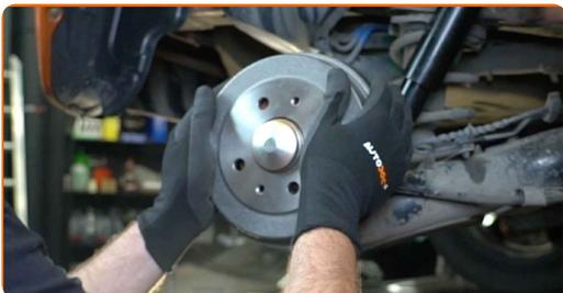
**19** Ziehen Sie die Halteklammern der Bremstrommeln an. Verwenden Sie Stecknuss Nr. 12. Verwenden Sie einen Drehmomentschlüssel. Ziehen Sie ihn mit 10 Nm Drehmoment fest.
