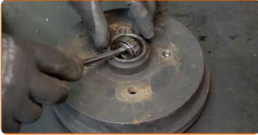
**13** Entfernen Sie die Nabenlagerhalterung. Benutzen Sie ein Brecheisen.
