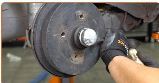
**7** Entfernen Sie den Sicherungssplint, der die Nabenmutter sichert. Benutzen Sie ein Brecheisen. Verwenden Sie einen flachen Schraubendreher.
