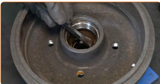
**16** Entfernen Sie den Innenring des Radlagers von der Bremstrommel. Verwenden Sie einen flachen Metallmeißel. Benutzen Sie einen Hammer.
