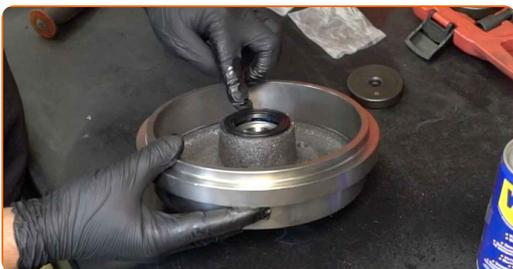
**25** Installieren Sie die Nabenlagerhalterung und sichern Sie diese.
