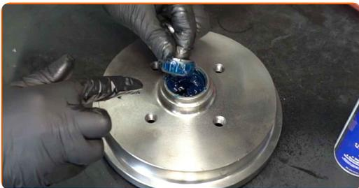
**26** Bauen Sie die mit dem Radnabenlager zusammengesetzte Bremstrommel ein.
