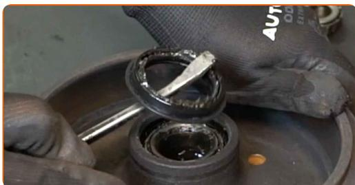
**12** Entfernen Sie die Nabenlagerhalterung. Benutzen Sie ein Brecheisen.
