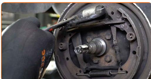
**12** Bewegen Sie die Feststellbremsbacken gegen die Trommel. Verwenden Sie Zangen.
