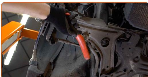
**7** Schrauben Sie das Befestigungselement heraus, das den Stabilisator mit dem Querlenker verbindet. Verwenden Sie Stecknuss Nr. 13. Verwenden Sie einen Ratschenschlüssel.
