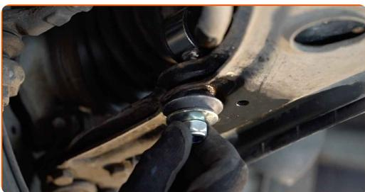
**11** Ziehen Sie das Befestigungselement an, das den Stabilisator mit dem Querlenker verbindet. Verwenden Sie Stecknuss Nr. 19. Verwenden Sie einen Drehmomentschlüssel. Ziehen Sie ihn mit 35 Nm Drehmoment fest.
