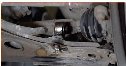
**8** Entfernen Sie die Stabilisatorstange. Benutzen Sie ein Brecheisen.
