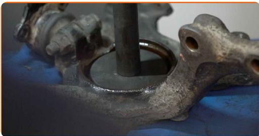
**39** Ziehen Sie den Lagerinnenring aus der Radnabe heraus. Verwenden Sie einen Druckstücksatz mit Ein-/Auspresswerkzeug. Verwenden Sie ein Trennmesser für Lager.
