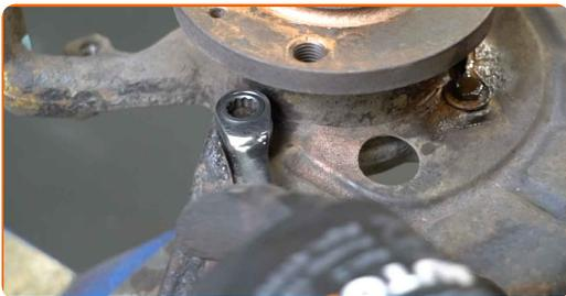
**31** Entfernen Sie das Bremsenabdeckblech.
