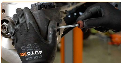
**11** Entfernen Sie den Bremssattel.
