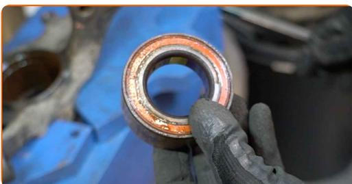
**40** Reinigen Sie den Einbauort für die Nabenlagerung. Benutzen Sie eine Drahtbürste. Benutzen Sie WD-40-Spray.
