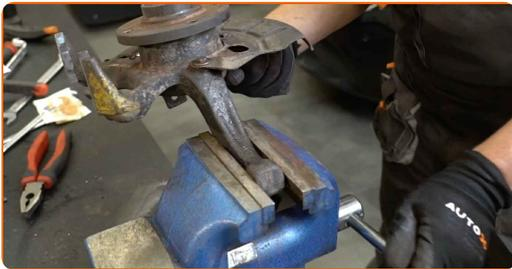
**52** Behandeln Sie den Federbeinbefestigungssitz am Achsschenkel. Benutzen Sie eine Drahtbürste. Benutzen Sie WD-40-Spray.
