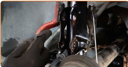
**53** Behandeln Sie die Keilwellen des Antriebswellen-Gleichlaufgelenks. Benutzen Sie eine Drahtbürste. Benutzen Sie WD-40-Spray.
