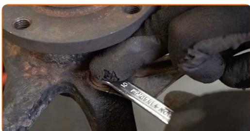
**50** Behandeln Sie die Radnabe an der Kontaktstelle mit der Bremsscheibe. Verwenden Sie Allzweckreinigungsspray.
