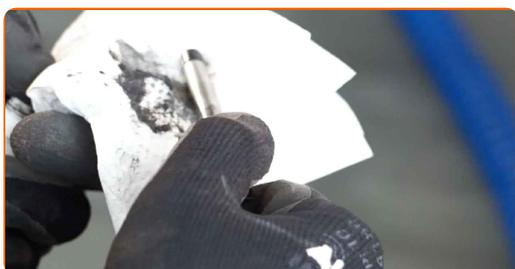
**18** Schmieren Sie die Führungsstifte mit Spezialbremsfett ein.
