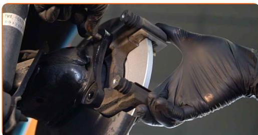
**23** Befestigen Sie die Bremssattelhalterung. Verwenden Sie Stecknuss Nr. 14. Verwenden Sie einen Drehmomentschlüssel. Ziehen Sie ihn mit 55 Nm Drehmoment fest.
