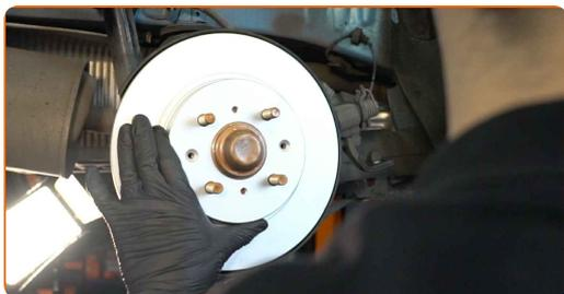
**20** Ziehen Sie die Befestigung der Bremsscheibe fest. Verwenden Sie einen Kreuzschlitzschraubendreher. Verwenden Sie einen Drehmomentschlüssel. Ziehen Sie ihn mit 9 Nm Drehmoment fest.
