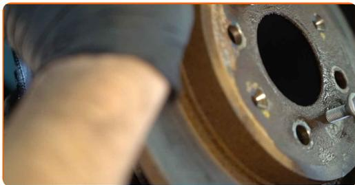
**18** Reinigen Sie die Nabe. Benutzen Sie eine Drahtbürste. Behandeln Sie die Kontaktfläche. Benutzen Sie ein Kupferschmiermittel.
