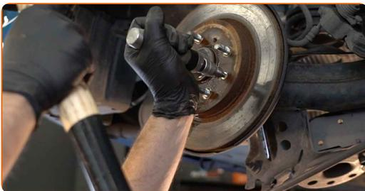
**17** Entfernen Sie die Bremsscheibe.
