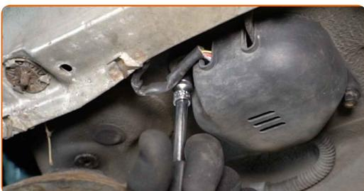
**5** Entfernen Sie den Deckel vom Sauerstoffsensorgehäuse.
