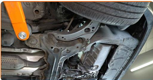
**4** Schrauben Sie die Befestigungen vom Deckel des Sauerstoffsensorgehäuses ab. Verwenden Sie Stecknuss Nr. 10. Verwenden Sie einen Ratschenschlüssel.
