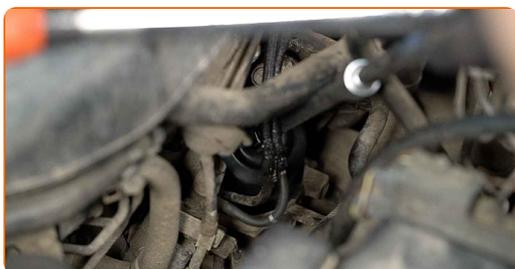
**20** Entfernen Sie die Öleinfüllschraube. Setzen Sie den Trichter ein.
