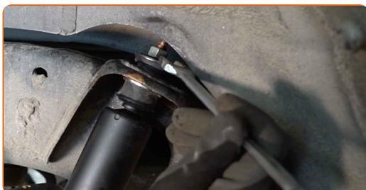
**18** Ziehen Sie die obere Stoßdämpferbefestigung an. Verwenden Sie Ring-Gabelschlüssel Nr. 12. Verwenden Sie Ring-Gabelschlüssel Nr. 17. Verwenden Sie einen Drehmomentschlüssel. Ziehen Sie ihn mit 40 Nm Drehmoment fest.
