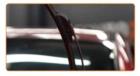
Drücken Sie auf die Klemme. Verwenden Sie einen flachen Schraubendreher. Entfernen Sie das Wischblatt vom Wischerarm.
