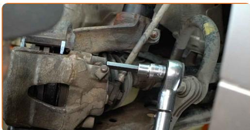
**20** Setzen Sie die Kappen auf die Führungsbolzenmanschetten des Bremssattels.
