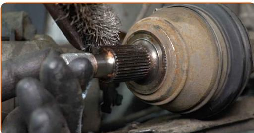
**49** Behandeln Sie die Keilwellen des Antriebswellen-Gleichlaufgelenks. Benutzen Sie ein Kupferschmiermittel.
