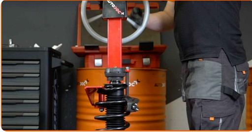
**46** Entfernen Sie das zusammengebaute Federbein.
