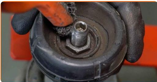
**32** Entfernen Sie die Mutter des Federbeinkolbens. Verwenden Sie eine 21 mm Schienenmutterstecknuss. Verwenden Sie Inbusschlüssel Nr. H7. Verwenden Sie einen Ratschenschlüssel.
