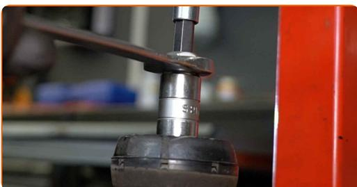
**33** Entfernen Sie das obere Federbeinlager.
