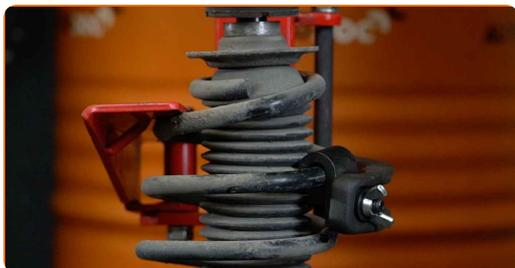
**31** Reinigen Sie die Kolbenstange des Federbeins. Benutzen Sie eine Drahtbürste. Benutzen Sie WD-40-Spray.
