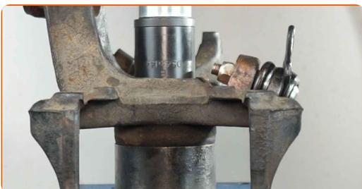
**43** Reinigen Sie den Einbauort für die Nabenlagerung. Benutzen Sie eine Drahtbürste. Benutzen Sie WD-40-Spray.
