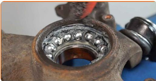
**41** Entfernen Sie den Sicherungsring am Radnabenlager. Verwenden Sie eine Sicherungsringzange.
