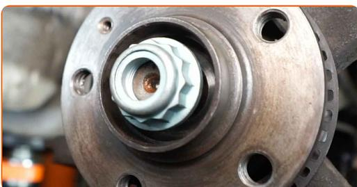
**66** Schrauben Sie die Befestigungen der Antriebswelle an. Verwenden Sie Stecknuss Nr. 30. Verwenden Sie einen Ratschenschlüssel.
