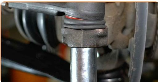
**21** Lösen Sie den Spurstangenkopf vom Achsschenkel. Verwenden Sie einen Kugelgelenkabzieher.
