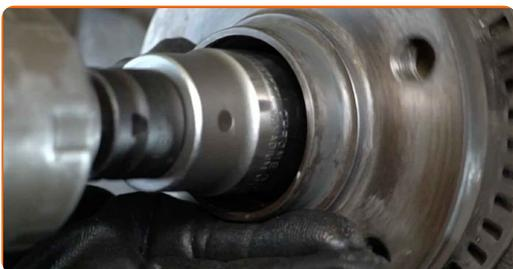
**18** Entfernen Sie die Befestigungsmutter.
