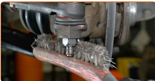
**20** Schrauben Sie die Befestigungsmutter ab, die den Spurstangenkopf mit dem Achsschenkel verbindet. Verwenden Sie Stecknuss Nr. 19. Verwenden Sie einen Ratschenschlüssel.
