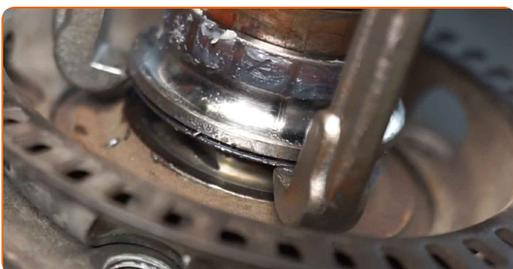
**47** Reinigen Sie den Befestigungssitz der Radnabe. Benutzen Sie eine Drahtbürste. Benutzen Sie WD-40-Spray.
