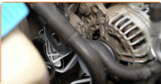
11 Drehen Sie die Kurbelwelle mehrmals, um zu überprüfen, ob der neue Keilrippenriemen sachgemäß funktioniert. Verwenden Sie Stecknuss Nr. 19. Verwenden Sie einen Ratschenschlüssel.
