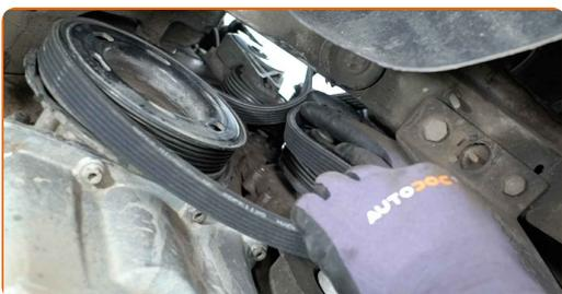
**8** Ziehen Sie die Spannrolle des Keilrippenriemens beiseite. Verwenden Sie Ring-Gabelschlüssel Nr. 16.
