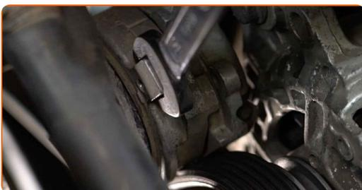
**5** Entfernen Sie den Keilrippenriemen.
