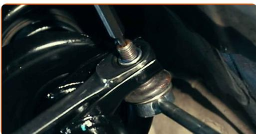
**12** Ziehen Sie das Befestigungselement an, das die Druckstange mit dem Federbein verbindet. Verwenden Sie Stecknuss Nr. 19. Verwenden Sie einen Drehmomentschlüssel. Ziehen Sie ihn mit 65 Nm Drehmoment fest.
