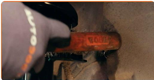
**7** Schrauben Sie das Befestigungselement heraus, das die Druckstange mit dem Federbein verbindet. Verwenden Sie Stecknuss Nr. 18. Benutzen Sie den XZN #6. Verwenden Sie einen Ratschenschlüssel.
