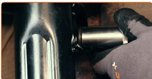
**8** Schrauben Sie das Befestigungselement heraus, das die Druckstange mit dem Stabilisator verbindet. Verwenden Sie Ring-Gabelschlüssel Nr. 18. Benutzen Sie den XZN #6. Verwenden Sie einen Ratschenschlüssel.
