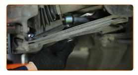
Ziehen Sie das Befestigungselement an, das den Stabilisator mit dem Querlenker verbindet. Verwenden Sie Stecknuss Nr. 13. Verwenden Sie einen Drehmomentschlüssel. Ziehen Sie ihn mit 25 Nm Drehmoment fest.
