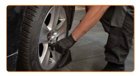
Entfernen Sie den Wagenheber sowie die Unterlegkeile.
