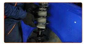
Schrauben Sie die obere Befestigung des Federbeinbefestigung an.
