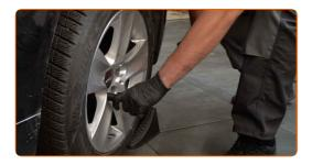
Entfernen Sie den Wagenheber sowie die Unterlegkeile.
