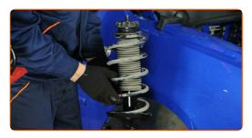
Stellen Sie das Dämpferbein auf das Federspannwerkzeug.
