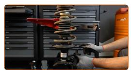
Installieren Sie das Federbein am Radlauf.
