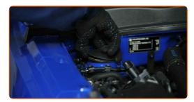
Lösen Sie die obere Befestigung der Federbeinbefestigung. Verwenden Sie Stecknuss Nr. 21. Verwenden Sie Inbusschlüssel Nr. H6. Verwenden Sie einen Ratschenschlüssel.
