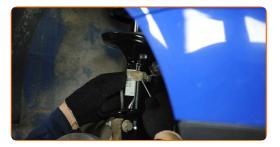
Trennen Sie die ABS Sensorverdrahtung.
