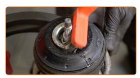
Entfernen Sie die Stangenmutter des Federkolben. Verwenden Sie Stecknuss Nr. 21. Verwenden Sie Inbusschlüssel Nr. H6. Verwenden Sie einen Ratschenschlüssel.
