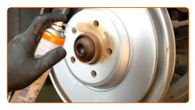
Die Bremsscheibenoberfläche reinigen. Benutzen Sie einen Bremsenreiniger.
