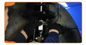
Verbinden Sie das ABS mit der Sensorverdrahtung.
