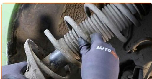
17 Stellen Sie das Dämpferbein auf das Federspannwerkzeug.
