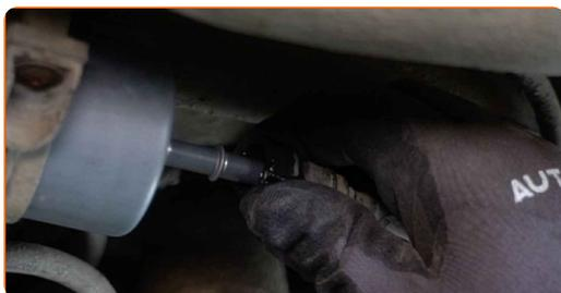
13 Reinigen Sie die Kraftstoffleitungen. Verwenden Sie Allzweckreinigungsspray.
