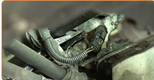
**3** Entfernen Sie den Kurbelwellensensor.
