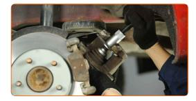
Reinigen Sie die Bremssattel-Führungsstifte.
