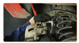
Installieren Sie die Staubschutzkappen der Bremssattel-Führungsstifte.
