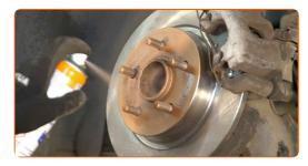
Die Bremsscheibenoberfläche reinigen. Benutzen Sie einen Bremsenreiniger.
