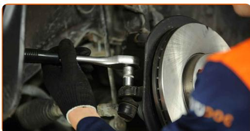
**12** Ziehen Sie den Spurstangenkopf vom Achsschenkel. Verwenden Sie einen Kugelgelenkabzieher.
