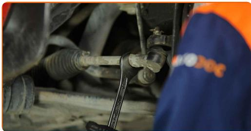
**9** Entfernen Sie den Splint. Verwenden Sie eine Kneifzange.
