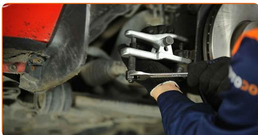
**13** Schrauben Sie das Ende aus der Zugstange.
