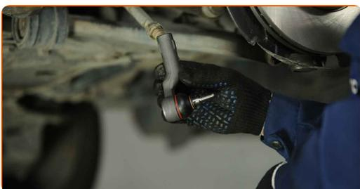
**Austausch: Spurstangenkopf – MAZDA 3 Hatchback (BK). Tipp von AUTODOC:**
