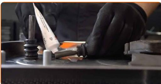
**23** Schrauben Sie die Führungsbolzen hinein.
