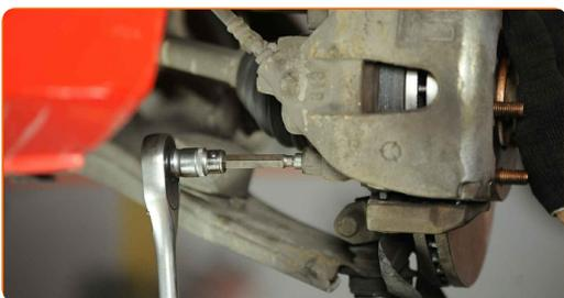
**25** Installieren Sie die Staubschutzkappen der Bremssattel-Führungsstifte.
