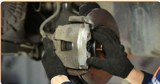
**21** Reinigen Sie die Bremssattel-Führungsstifte.
