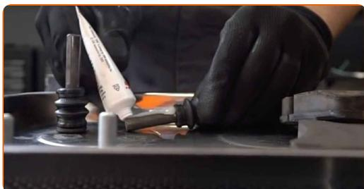
**23** Schrauben Sie die Führungsbolzen hinein.
