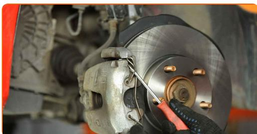
**8** Entfernen Sie die Staubschutzkappen der Bremssattel-Führungsstifte. Verwenden Sie einen flachen Schraubendreher.
