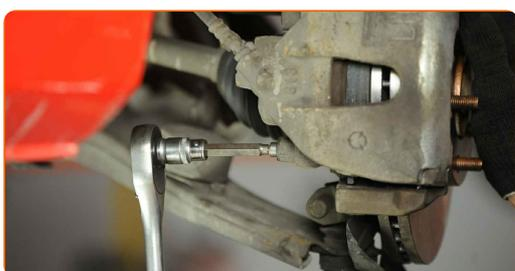
**25** Installieren Sie die Staubschutzkappen der Bremssattel-Führungsstifte.
