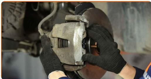
**21** Reinigen Sie die Bremssattel-Führungsstifte.
