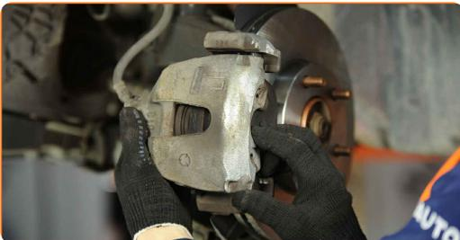
**Austausch: Bremsbeläge – MAZDA 5 (CW). Tipp von AUTODOC:**
