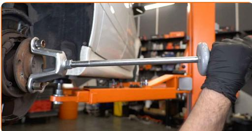
**22** Reinigen Sie den Einbauort für die Nabenlagerung. Benutzen Sie eine Drahtbürste. Benutzen Sie WD-40-Spray.
