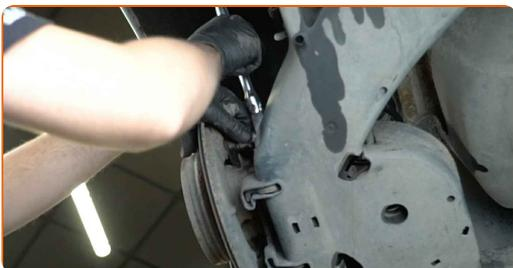
**13** Entfernen Sie die Sattelhalterung.
