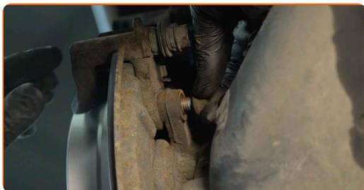
**32** Befestigen Sie die Bremssattelhalterung. Verwenden Sie Stecknuss Nr. 16. Verwenden Sie einen Drehmomentschlüssel. Ziehen Sie ihn mit 55 Nm Drehmoment fest.
