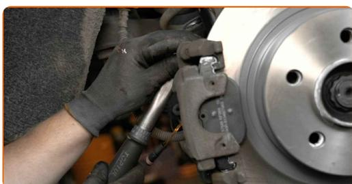
**26** Installieren Sie die Staubschutzkappen der Bremssattel-Führungsstifte.
