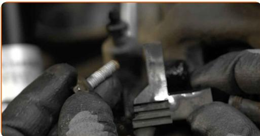
**11** Lösen Sie den Kabelbaum des Bremsbelagverschleißsensors.
