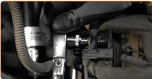
**10** Entfernen Sie die Befestigungsschraube.
