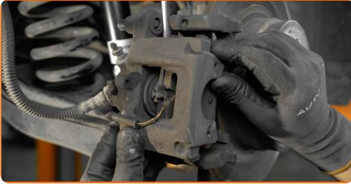
**Austausch: Bremsbelagverschleißsensor – MERCEDES-BENZ C-Klasse Sportcoupe (CL203). Tipp:**
