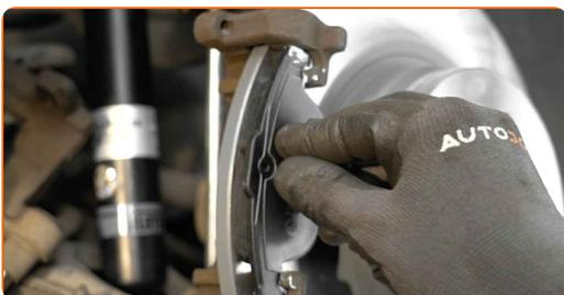
**24** Installieren Sie den Bremssattel und fixieren Sie diesen.
