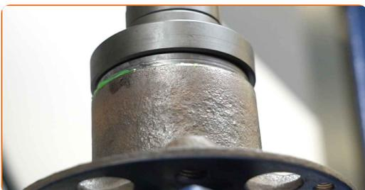
**41** Bauen Sie den neuen O-Ring ein. Verwenden Sie einen Druckstücksatz mit Ein-/Auspresswerkzeug.
