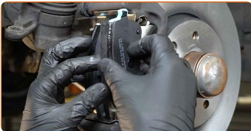
**61** Installieren Sie den Bremssattel und fixieren Sie diesen. Verwenden Sie Stecknuss Nr. 12. Verwenden Sie einen Drehmomentschlüssel. Ziehen Sie ihn mit 25 Nm Drehmoment fest.
