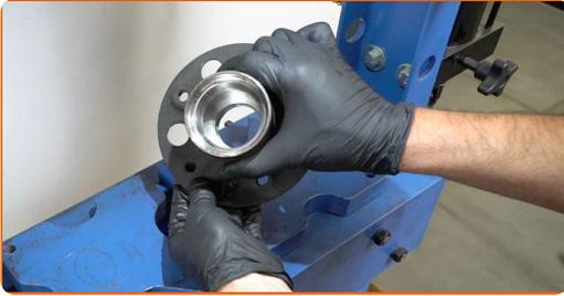
**30** Ziehen Sie den Lagerinnenring aus der Radnabe heraus. Verwenden Sie einen Druckstücksatz mit Ein-/Auspresswerkzeug.
