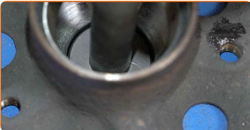
**31** Ziehen Sie den Lagerinnenring aus der Radnabe heraus. Benutzen Sie einen dreiarmligen Abzieher. Verwenden Sie einen Druckstücksatz mit Ein-/Auspresswerkzeug.
