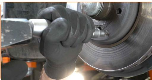
**18** Entfernen Sie die Bremsscheibe.
