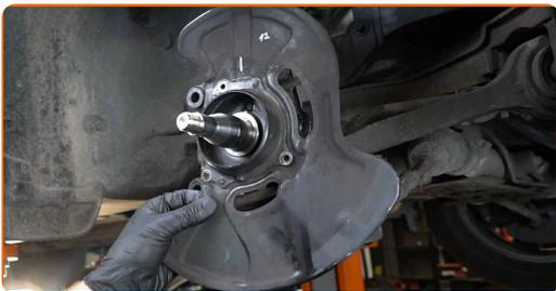
**47** Drehen Sie die Befestigungen des Bremsenabdeckblechs ein. Verwenden Sie Stecknuss Nr. E12. Verwenden Sie einen Drehmomentschlüssel. Ziehen Sie ihn mit 11 Nm Drehmoment fest.
