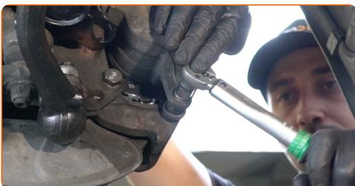
**62** Bringen Sie den Steckverbinder des Verschleißsensors der Bremsbeläge an.
