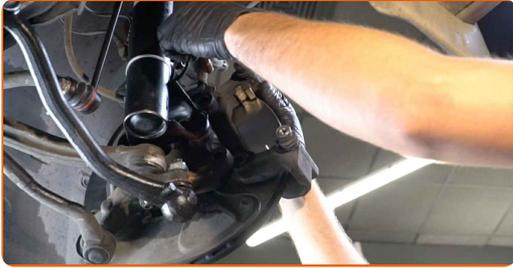
**59** Befestigen Sie die Bremssattelhalterung. Verwenden Sie Stecknuss Nr. 18. Verwenden Sie einen Drehmomentschlüssel. Ziehen Sie ihn mit 115 Nm Drehmoment fest.
