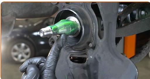
**49** Die neue Radnabe mit einem Lager montieren.
