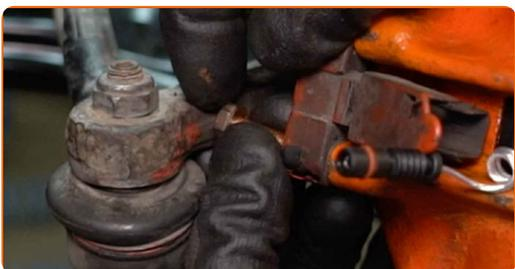
**64** Schrauben Sie die Befestigungsschraube des Steckers des Bremsbelagverschleißsensors ein. Verwenden Sie Ring-Gabelschlüssel Nr. 10.
