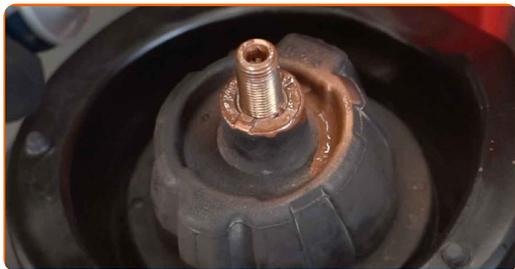
**44** Dekomprimieren Sie die Feder.
