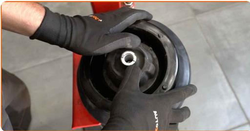
**42** Ziehen Sie die Federbeinkolbenstangenmutter an. Verwenden Sie eine 14X2.5 mm Schienenmutterstecknuss. Verwenden Sie Stecknuss Nr. 21. Verwenden Sie Inbusschlüssel Nr. H6. Verwenden Sie einen Drehmomentschlüssel. Ziehen Sie ihn mit 20 Nm Drehmoment fest.
