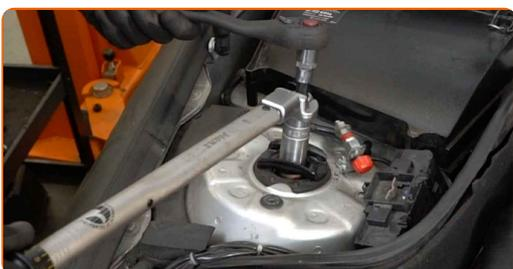
**73** Behandeln Sie die Befestigungselemente des Federbeinstützlagers. Benutzen Sie ein Kupferschmiermittel.
