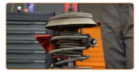
Behandeln Sie die Federbeinstange. Benutzen Sie eine Drahtbürste. Benutzen Sie WD-40-Spray.
