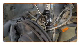
Lösen Sie die obere Befestigung der Federbeinbefestigung.
