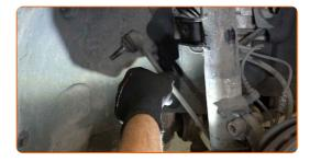
Ziehen Sie den Bremsschlauch Halterung ab. Verwenden Sie eine Kneifzange.
