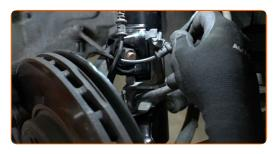
Verbinden Sie das Bremsbelagverschleißkabel.
