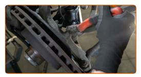
Befestigen Sie das Dämpferbein auf dem Achsschenkel. Benutzen Sie ein Brecheisen.
