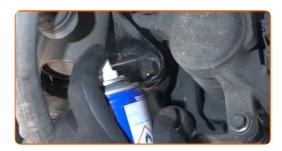
Schrauben Sie die Befestigungen ab, die das Federbein mit dem Achsschenkel verbinden. Verwenden Sie Stecknuss Nr. 19. Verwenden Sie ein Windeisen.
