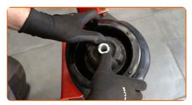
Ziehen Sie die Federbeinkolbenstangenmutter an. Verwenden Sie eine 14X2.5 mm Schienenmutterstecknuss. Verwenden Sie Stecknuss Nr. 21. Verwenden Sie Inbusschlüssel Nr. H6. Verwenden Sie einen Drehmomentschlüssel. Ziehen Sie ihn mit 20 Nm Drehmoment fest.
