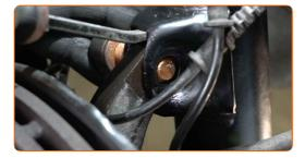
Schrauben Sie die obere Befestigung ein, die das Federbein mit dem Achsschenkel verbindet. Verwenden Sie Stecknuss Nr. 21. Verwenden Sie Inbusschlüssel Nr. H12. Verwenden Sie einen Ratschenschlüssel.
