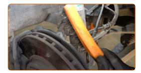
Schrauben Sie die obere Befestigung ab, die das Federbein mit dem Achsschenkel verbindet. Verwenden Sie Inbusschlüssel Nr. H12. Verwenden Sie Stecknuss Nr. 21. Verwenden Sie einen Ratschenschlüssel. Verwenden Sie ein Windeisen.
