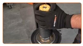
Installieren Sie die Feder am Stoßdämpfer.
