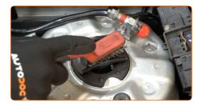
Lösen Sie die oberen Befestigungselemente des Federbeinstützlagers. Verwenden Sie Ring-Gabelschlüssel Nr. 21. Verwenden Sie Inbusschlüssel Nr. H7. Verwenden Sie einen Ratschenschlüssel.
