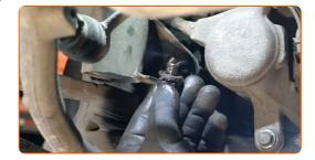
Ziehen Sie den Achsschenkel vom Dämpferbein ab. Benutzen Sie ein Brecheisen.
