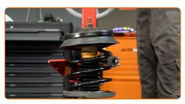
Entfernen Sie das zusammengebaute Federbein.
