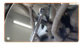
20 Entfernen Sie die Befestigungsschrauben.
