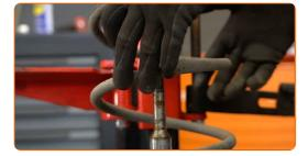
Die Staubkappe des Stoßdämpfers und den Anschlagpuffer entfernen.
