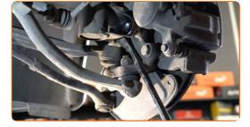
Stützen Sie die Achsschenkel auf. Benutzen Sie einen hydraulischen Getriebeheber.
