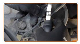
Trennen Sie das Bremsbelagverschleißkabel ab.
