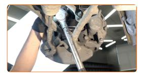
Schrauben Sie die obere Befestigung fest, die das Federbein mit dem Achsschenkel verbindet. Verwenden Sie Stecknuss Nr. 21. Verwenden Sie Inbusschlüssel Nr. H12. Verwenden Sie einen Drehmomentschlüssel. Ziehen Sie ihn mit 100 Nm Drehmoment fest.+90°
