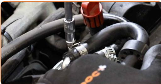
**19** Reinigen Sie die Abdeckung und das Gehäuse des Kraftstofffilters. Verwenden Sie Allzweckreinigungsspray.
