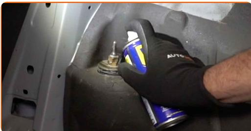
**10** Schrauben Sie das obere Befestigungselement des Stoßdämpfers ab. Verwenden Sie Ring-Gabelschlüssel Nr. 17. Verwenden Sie einen Stoßdämpfer Steckschlüsseleinsatz Nr. DD6. Verwenden Sie einen Ratschenschlüssel.
