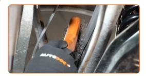
Schrauben Sie das Befestigungselement heraus, das die Druckstange mit dem Stabilisator verbindet. Verwenden Sie Ring-Gabelschlüssel Nr. 11. Verwenden Sie Stecknuss Nr. 16. Verwenden Sie einen Ratschenschlüssel.
