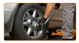
Entfernen Sie den Wagenheber sowie die Unterlegkeile.
