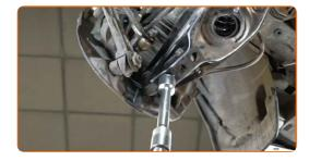
Ziehen Sie die Befestigungen an, die die Koppelstange mit dem Achsschenkel verbinden. Verwenden Sie Stecknuss Nr. E14. Verwenden Sie einen Drehmomentschlüssel. Ziehen Sie ihn mit 40 Nm Drehmoment fest.
