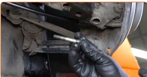
**16** Entfernen Sie den Stoßdämpfer.
