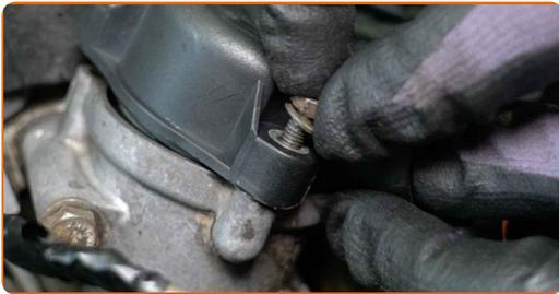
**20** Ziehen Sie die Befestigungselemente des Thermostatgehäuses fest. Verwenden Sie Stecknuss Nr. 10. Verwenden Sie einen Drehmomentschlüssel. Ziehen Sie ihn mit 12 Nm Drehmoment fest.
