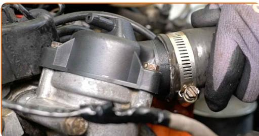
**22** Sichern Sie die Klemme des Kühlmittelschlauchs. Verwenden Sie Stecknuss Nr. 8. Verwenden Sie einen Ratschenschlüssel.
