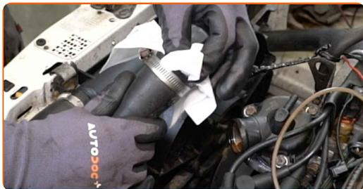
**12** Schrauben Sie die Befestigungselemente des Thermostatgehäuses ab. Verwenden Sie Stecknuss Nr. 10. Verwenden Sie einen Ratschenschlüssel.
