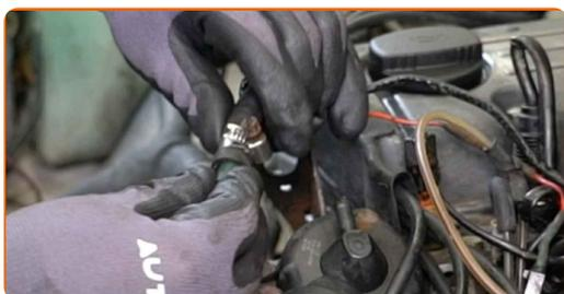
**11** Lösen Sie den Kühlmittelschlauch.
