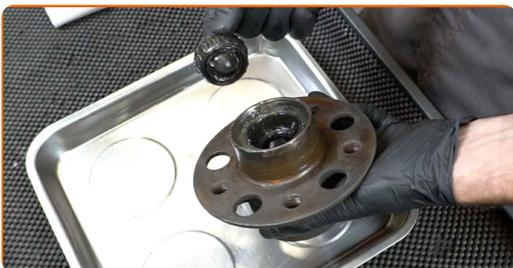
**31** Entfernen Sie den alten O-Ring. Benutzen Sie ein Brecheisen.
