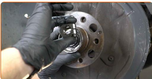
**28** Entfernen Sie die Nabe und das Lager zusammen, da sie eine versiegelte Einheit sind.
