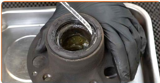
**32** Entfernen Sie das Radnabenlager.
