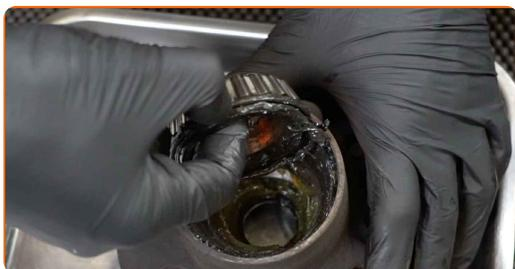
**33** Reinigen Sie den Einbauort für die Nabenlagerung.
