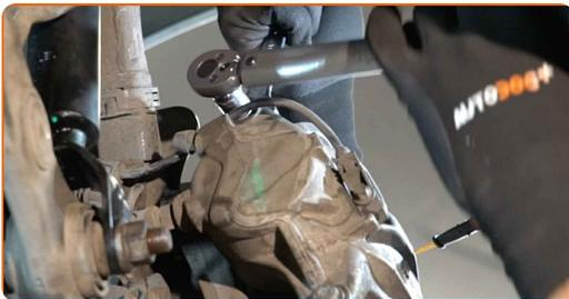
**61** Bringen Sie den Steckverbinder des Verschleißsensors der Bremsbeläge an.
