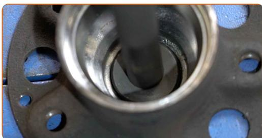
**35** Ziehen Sie den Lagerinnenring aus der Radnabe heraus. Benutzen Sie einen dreiarmligen Abzieher. Verwenden Sie einen Druckstücksatz mit Ein-/Auspresswerkzeug.
