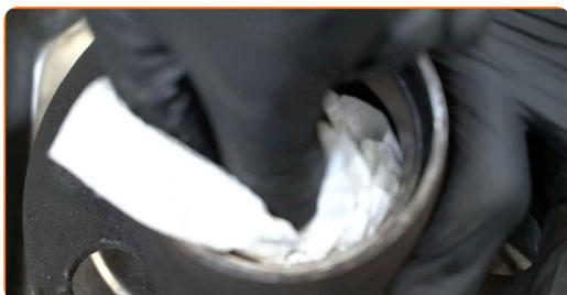
**34** Ziehen Sie den Lagerinnenring aus der Radnabe heraus. Verwenden Sie einen Druckstücksatz mit Ein-/Auspresswerkzeug.
