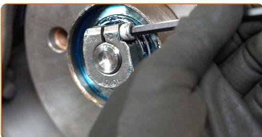
**70** Behandeln Sie das Radnabenlager. Verwenden Sie Mehrzweckfett.
