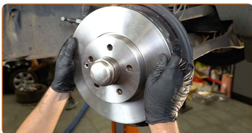
**53** Ziehen Sie die Befestigung der Bremsscheibe fest. Verwenden Sie den Torx T30. Verwenden Sie einen Drehmomentschlüssel. Ziehen Sie ihn mit 8 Nm Drehmoment fest.
