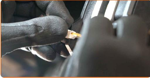
**59** Drücken Sie den Bremssattelkolben rein. Verwenden Sie den Bremskolbenrücksteller.
