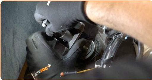
**60** Installieren Sie den Bremssattel und fixieren Sie diesen. Verwenden Sie Ring-Gabelschlüssel Nr. 17. Verwenden Sie Stecknuss Nr. 13. Verwenden Sie einen Drehmomentschlüssel. Ziehen Sie ihn mit 35 Nm Drehmoment fest.
