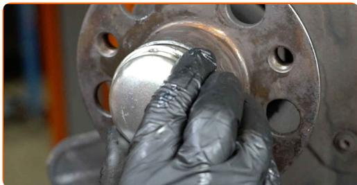
**51** Reinigen Sie die Nabe. Benutzen Sie eine Drahtbürste. Behandeln Sie die Kontaktfläche. Benutzen Sie ein Kupferschmiermittel.
