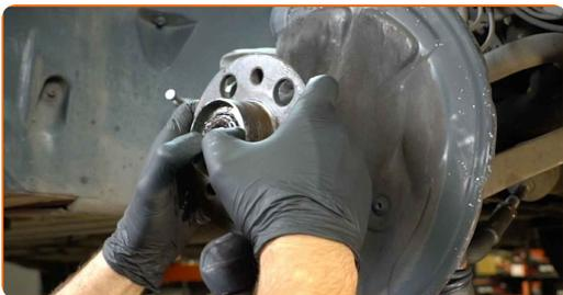
**29** Reinigen Sie den Befestigungssitz der Radnabe. Verwenden Sie Allzweckreinigungsspray.
