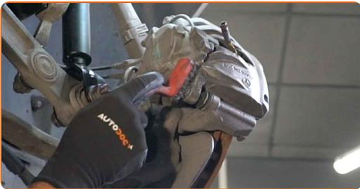
**12** Schrauben Sie die Befestigung des Bremssattels ab. Verwenden Sie Ring-Gabelschlüssel Nr. 17. Verwenden Sie Stecknuss Nr. 13. Verwenden Sie einen Ratschenschlüssel.
