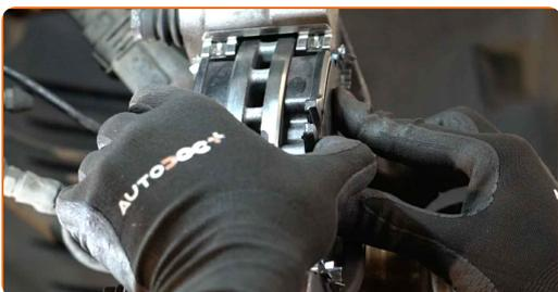
**58** Verbinden Sie den Bremsbelag-Verschleiß-Sensor.
