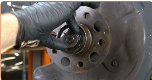
**27** Entfernen Sie die Befestigungsmutter.
