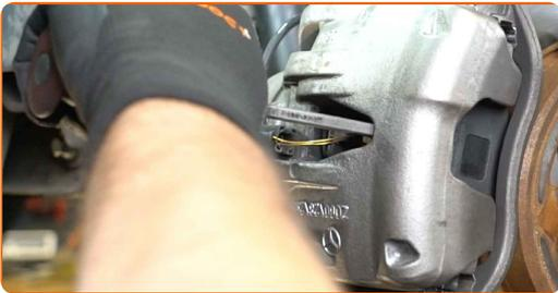
**11** Die Bremssattelbefestigungen reinigen. Benutzen Sie eine Drahtbürste. Benutzen Sie WD-40-Spray.
