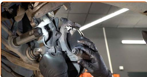
**56** Befestigen Sie die Bremssattelhalterung. Verwenden Sie Stecknuss Nr. 21. Verwenden Sie einen Drehmomentschlüssel. Ziehen Sie ihn mit 115 Nm Drehmoment fest.
