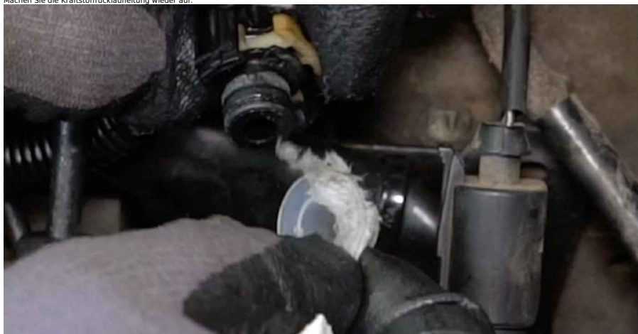
21 Schließen Sie den Schlauch der Kraftstoffrücklaufleitung an.
