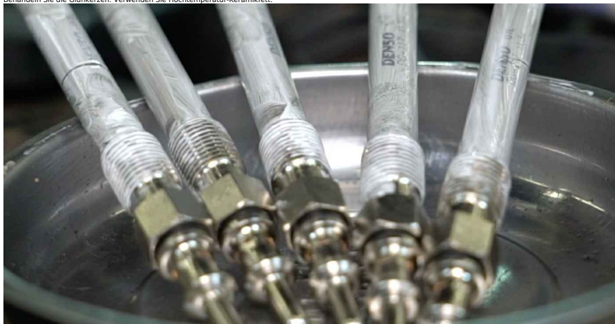
15 Bauen Sie neue Glühkerzen in ihre Befestigungssitze ein. Verwenden Sie eine Spitzzange.
