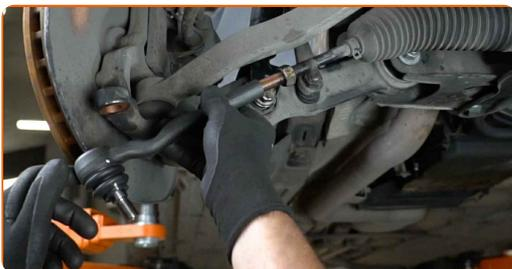
**Austausch: Spurstangenkopf – MERCEDES-BENZ E-Klasse Pritsche / Fahrgestell (VF211). Fachleute empfehlen:**
