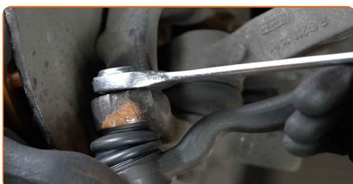
**17** Schrauben Sie die Feststellmutter des Spurstangenkopfes auf. Verwenden Sie Ring-Gabelschlüssel Nr. 21 (2 Teile).
