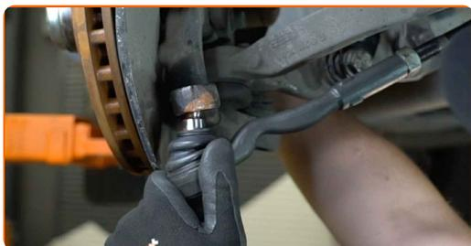
**16** Schrauben Sie die Befestigungsmutter auf, die den Spurstangenkopf mit dem Achsschenkel verbindet. Verwenden Sie Ring-Gabelschlüssel Nr. 22.
