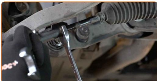
**18** Ziehen Sie die Spurstangenkopf Sicherungsmutter an. Verwenden Sie Ring-Gabelschlüssel Nr. 21 (2 Teile). Verwenden Sie einen Drehmomentschlüssel. Ziehen Sie ihn mit 60 Nm Drehmoment fest.
