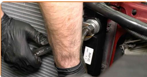
**35** Befestigen Sie die unteren Kühlmittelschläuche.
