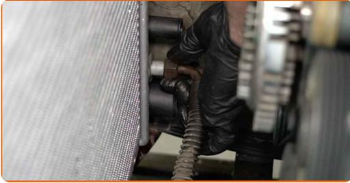
**34** Schrauben Sie die Befestigungsmuttern an, die die Kühlerleitungen des Automatikgetriebes mit dem Kühler verbinden. Verwenden Sie Ring-Gabelschlüssel Nr. 19.
