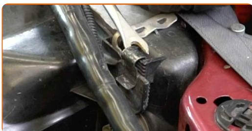
**17** Lösen Sie die Schellen des oberen Kühlmittelschlauchs. Verwenden Sie Stecknuss Nr. 7. Verwenden Sie einen Ratschenschlüssel.
