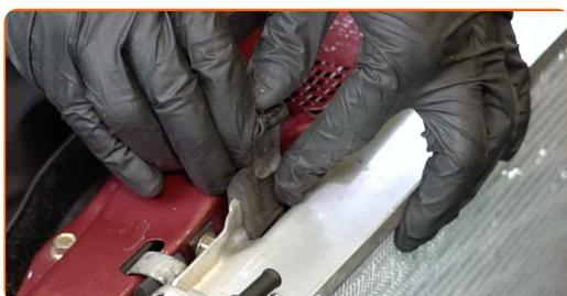
**33** Schließen Sie die Kühlerleitungen des Automatikgetriebes an den Kühler an.
