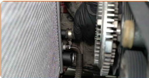
**36** Ziehen Sie die Schellen der unteren Kühlmittelschläuche fest. Verwenden Sie Stecknuss Nr. 7. Verwenden Sie einen Ratschenschlüssel.
