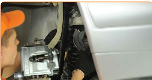
**24** Entfernen Sie den Spiralfederspanner.
