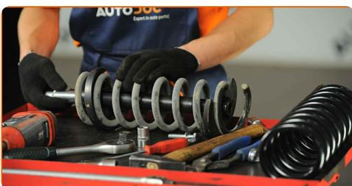
**16** Reinigen Sie die Aufnahmen der Spiralfedern.
