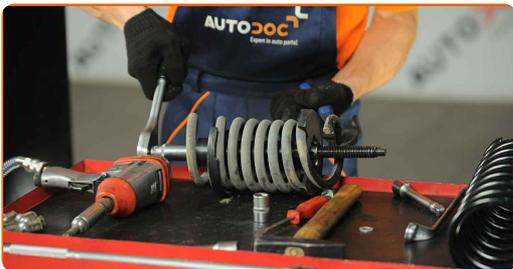
**14** Dekomprimieren Sie die Feder.
