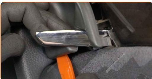
**7** Schrauben Sie die Befestigung der Türverkleidung ab. Verwenden Sie einen Kreuzschlitzschraubendreher.
