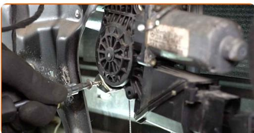
**32** Schließen Sie die Steckverbindung an den Motor des elektrischen Fensterhebers an.
