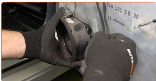
**41** Schrauben Sie die Befestigungselemente des Lautsprechers ein. Verwenden Sie einen Kreuzschlitzschraubendreher.
