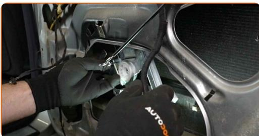
**30** Setzen Sie die Nieten des Fensterhebers ein. Verwenden Sie eine Blindnietzange. Verwenden Sie 4,8-mm-Nieten.
