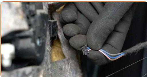
**12** Entfernen Sie die Leuchte. Verwenden Sie einen Zierleistenkeil.
