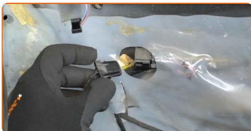
**17** Lösen Sie die Schalldämmung des Türblechs.
