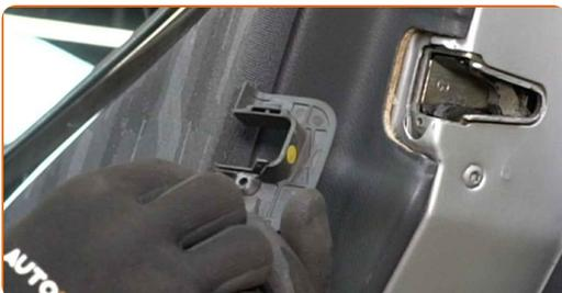
**4** Entfernen Sie die Abdeckung der Befestigung der Türverkleidung. Verwenden Sie einen Zierleistenkeil.
