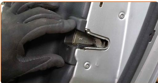
**53** Schrauben Sie die Befestigungsschraube der Abdeckung des Türschlosses ein. Verwenden Sie einen Kreuzschlitzschraubendreher.
