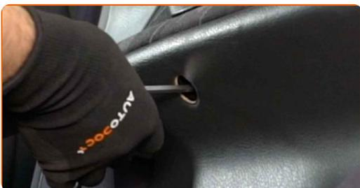
**6** Lösen Sie die Türgriffverkleidung. Verwenden Sie einen Zierleistenkeil.
