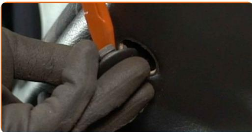
**5** Schrauben Sie die Befestigung der Türverkleidung ab. Verwenden Sie einen Kreuzschlitzschraubendreher.
