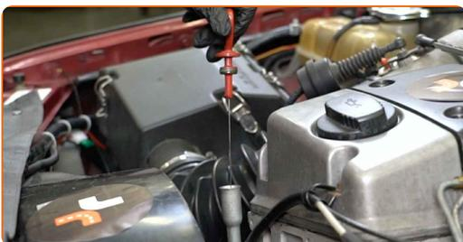
4 Schrauben Sie die Öleinfüllschraube ab.
