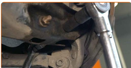
**16** Ziehen Sie das Befestigungselement an, das die Druckstange mit dem Stabilisator verbindet. Verwenden Sie Ring-Gabelschlüssel Nr. 17. Verwenden Sie Ring-Gabelschlüssel Nr. 22. Verwenden Sie einen Drehmomentschlüssel. Ziehen Sie ihn mit 50 Nm Drehmoment fest.
