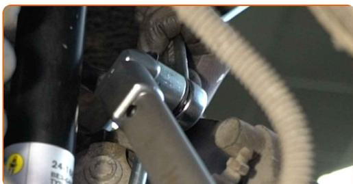
**17** Entfernen Sie die Abstützung unter dem hinteren Achsschenkel.
