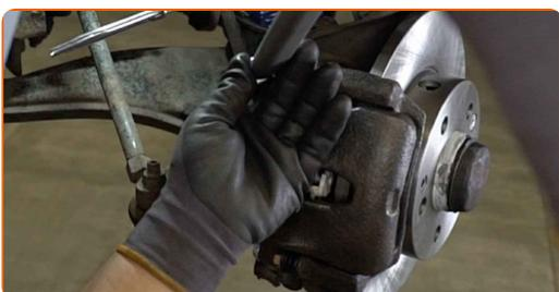
**54** Verbinden Sie den Schlauch des Bremsentlüftungs-Kits mit der Bremsentlüftungsschraube.
