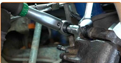
**53** Ziehen Sie das Befestigungselement an, das die Bremsleitung mit dem Bremssattel verbindet. Verwenden Sie Ring-Gabelschlüssel Nr. 14. Verwenden Sie einen Drehmomentschlüssel. Ziehen Sie ihn mit 18 Nm Drehmoment fest.
