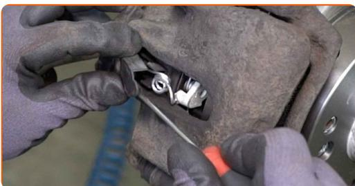
**9** Reinigen Sie die Befestigungsschraube des Steckers des Bremsbelagverschleißsensors. Benutzen Sie eine Drahtbürste. Benutzen Sie WD-40-Spray.
