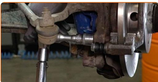
**48** Schrauben Sie den Bremsschlauch in den Bremssattel.
