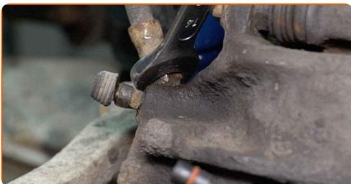
**16** Die Bremssattelbefestigungen reinigen. Benutzen Sie eine Drahtbürste. Benutzen Sie WD-40-Spray.
