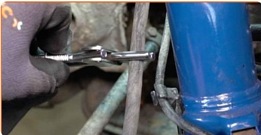
**15** Lockern Sie die Befestigung des Bremsschlauchs. Verwenden Sie Ring-Gabelschlüssel Nr. 14.
