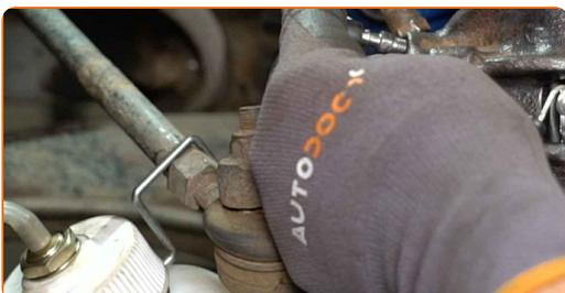
**55** Entfernen Sie die Bremsschlauchklemmen.
