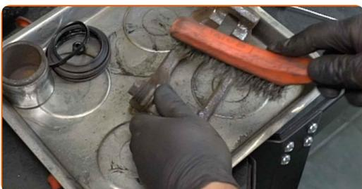
**40** Entfernen Sie die Bremssattelführungsbolzen.
