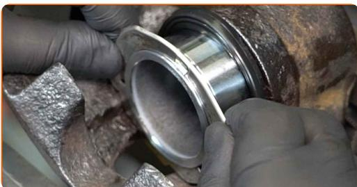
**37** Drücken Sie den Bremssattelkolben ein. Verwenden Sie den Bremskolbenrücksteller.
