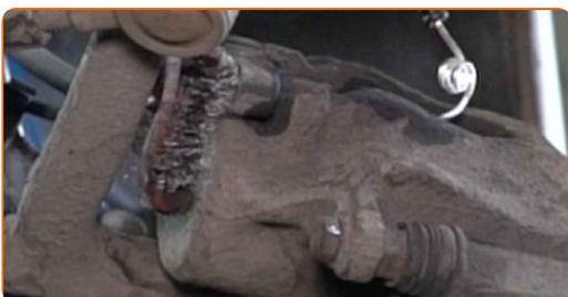
**10** Lösen Sie die Befestigungsschraube des Steckers des Bremsbelagverschleißsensors. Verwenden Sie Ring-Gabelschlüssel Nr. 10.
