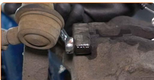
**11** Entfernen Sie die Befestigungsschraube.
