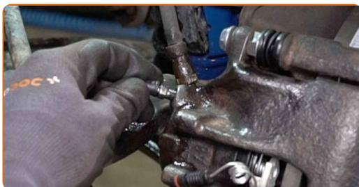
**61** Montieren Sie den Stecker des Bremsbelagverschleißsensors.
