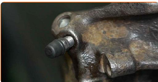
**39** Entfernen Sie Schmutz und Staub vom Bremssattelhalter. Benutzen Sie eine Drahtbürste. Verwenden Sie Allzweckreinigungsspray.
