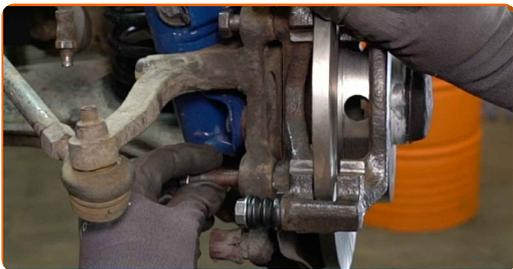
**47** Ziehen Sie die Befestigungen des Bremssattelhalters fest. Verwenden Sie Stecknuss Nr. 19. Verwenden Sie einen Drehmomentschlüssel. Ziehen Sie ihn mit 115 Nm Drehmoment fest.
