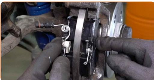
**50** Bauen Sie den Bremssattel ein und befestigen Sie diesen.
