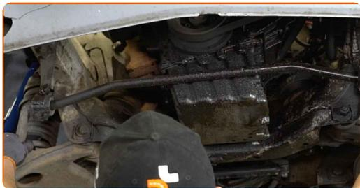
**14** Reinigen Sie das Verbindungselement, welches das Kugelgelenk mit dem Achsschenkel verbindet. Benutzen Sie eine Drahtbürste. Benutzen Sie WD-40-Spray.
