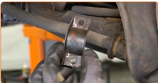
**13** Lösen Sie den Stabilisator von den Achslenkern.
