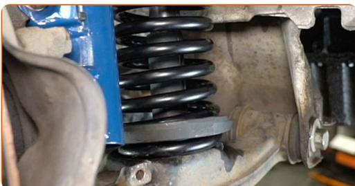
**35** Entfernen Sie den Spiralfederspanner.
