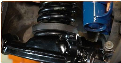
**34** Entfernen Sie den Spiralfederspanner.
