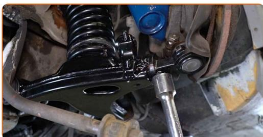
**36** Richten Sie die Position der Sturzschrauben entsprechend den Markierungen aus.
