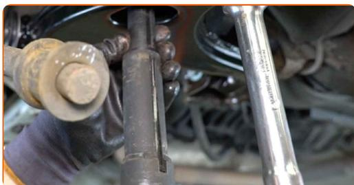
**35** Zum korrekten Anziehen der Befestigungen müssen Sie die Komponenten der Aufhängung in ihre Arbeitsposition heben.
