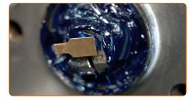
Bauen Sie die Schutzkappe des Nabenlagers ein. Verwenden Sie einen Druckstücksatz mit Ein-/Auspresswerkzeug. Benutzen Sie einen Hammer.
