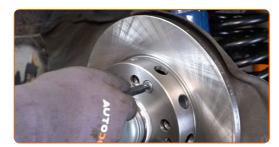
Schrauben Sie die Befestigungen der Bremsscheibe fest. Verwenden Sie Inbusschlüssel Nr. H5. Verwenden Sie einen Drehmomentschlüssel. Ziehen Sie ihn mit 10 Nm Drehmoment fest.
