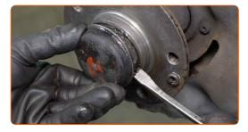
19 Entfernen Sie die Kontaktfeder.
