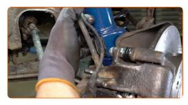
Die Befestigungselemente der Bremssattelhalterung reinigen. Benutzen Sie eine Drahtbürste. Benutzen Sie WD-40-Spray.
