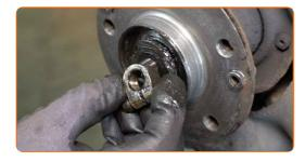
Entfernen Sie die Radnabe zusammen mit dem Lager. Verwenden Sie einen Universalabzieher.
