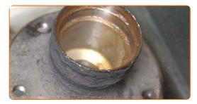
Montieren Sie die Außenringe der neuen Radlager. Verwenden Sie einen Druckstücksatz mit Ein-/Auspresswerkzeug.
