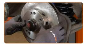
Entfernen Sie die Schutzkappe des Nabenlagers. Benutzen Sie ein Brecheisen. Benutzen Sie einen Hammer.
