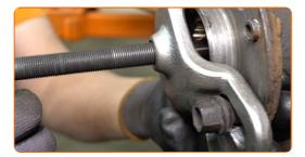
Reinigen Sie den Achszapfen. Verwenden Sie Allzweckreinigungsspray.
