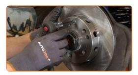
Entfernen Sie die Befestigungsschraube.
