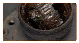
Demontieren Sie die Lageraußenringe. Verwenden Sie einen Druckstücksatz mit Ein-/Auspresswerkzeug. Verwenden Sie einen Universalabzieher.
