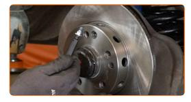
17 Entfernen Sie die Bremsscheibe.
