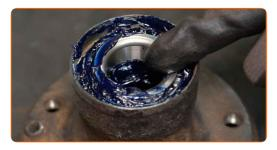
Drücken Sie den inneren Dichtring des Radlagers ein. Verwenden Sie einen Druckstücksatz mit Ein-/Auspresswerkzeug.
