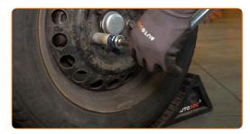
Entfernen Sie den Wagenheber sowie die Unterlegkeile.
