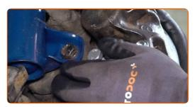
Ziehen Sie die Befestigungen des Bremssattelhalters fest. Verwenden Sie Stecknuss Nr. 19. Verwenden Sie einen Drehmomentschlüssel. Ziehen Sie ihn mit 115 Nm Drehmoment fest.
