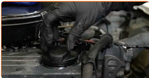
**26** Befestigen Sie den Deckel des Öleinfüllstutzens.
