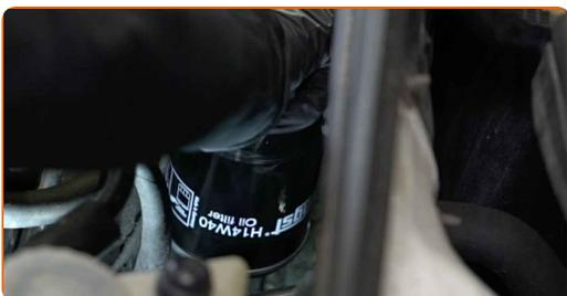
**16** Ziehen Sie die Befestigungselemente des Ölfilter fest. Denken Sie daran, das empfohlene Anzugsdrehmoment einzuhalten. Verwenden Sie Steckschlüssel 76/14F. Verwenden Sie einen Drehmomentschlüssel. Ziehen Sie ihn mit 20 Nm Drehmoment fest.
