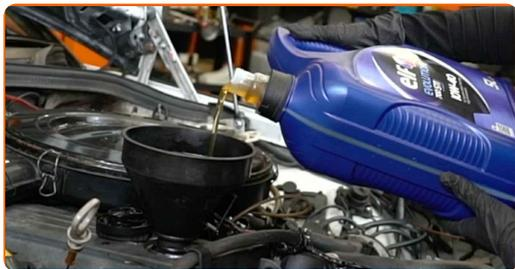
Austausch: Motoröl und Ölfilter – MERCEDES-BENZ S-Klasse Limousine (W126). AUTODOC empfiehlt:
