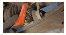
Schrauben Sie das Befestigungselement heraus, das die Druckstange mit dem Stabilisator verbindet. Verwenden Sie Ring-Gabelschlüssel Nr. 16. Verwenden Sie Ring-Gabelschlüssel Nr. 22.
