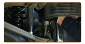
Schrauben Sie die Befestigungen heraus, die die Koppelstange mit dem Achsschenkel verbinden. Verwenden Sie Ring-Gabelschlüssel Nr. 16. Verwenden Sie Stecknuss Nr. 16. Verwenden Sie einen Ratschenschlüssel.
