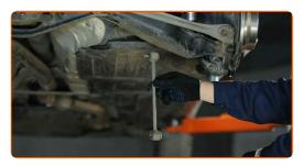
Reinigen Sie die Montagesitze der Koppelstange. Benutzen Sie eine Drahtbürste. Benutzen Sie WD-40-Spray.
